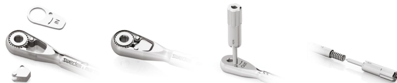
Dopo aver lubrificato le parti indicate in figura, inserire i due elementi che compongono la testa del cricchetto nella seguente sequenza: ruota a nottolino dentellata e successivamente il dente ferma ruota.
