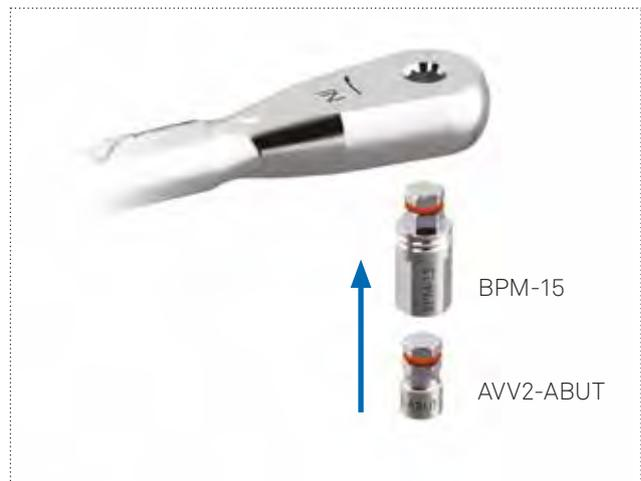
Per stabilizzare l'asse di lavoro del cricchetto e degli strumenti ad esso assemblati si consiglia di appoggiare il dito indice della mano non occupata sul nottolino della testa del cricchetto stesso.
