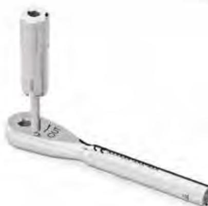
Dopo aver rimosso il coperchio, estrarre i due componenti contenuti all'interno della testa del cricchetto: la ruota a nottolino dentellata e il dente ferma ruota.
