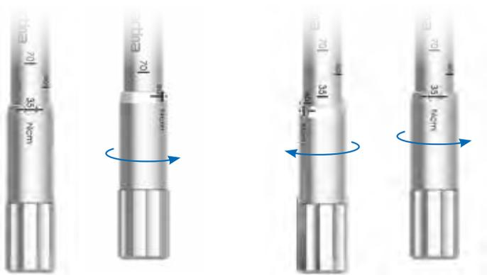
Per regolare il torque in crescita è sufficiente ruotare la ghiera in senso orario.
