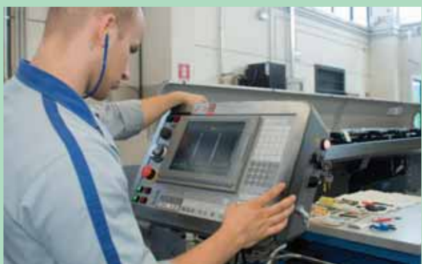
Il tornio a controllo numerico è una macchina di alta precisione che occorre programmare. Nell’immagine, un momento della delicata operazione
