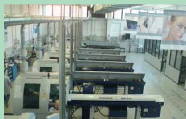
"Panoramica reparto tornerie" - Sguardo d'insieme su reparto torneria, dove la semplice barra di titanio inizia il lungo viaggio verso la sua nobile trasformazione in impianto biocompatibile.
