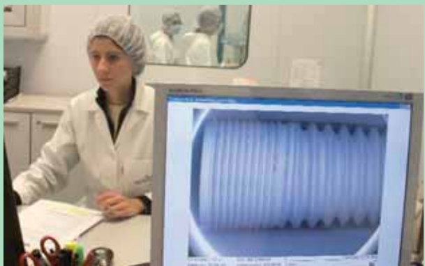
Nella “Camera Bianca” il microscopio elettronico a scansione svolge un compito eccellente (in genere esaustivo) nel rivelare eventuali criticità del “pezzo”, che non sfuggiranno tuttavia all’operatrice.
